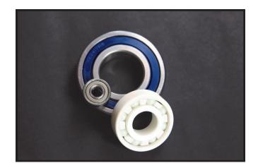
Während die Hybrid-Kugellager vor allem durch Geschwindigkeit/Gewicht, Präzision/Härte und Langlebigkeit überzeugen, bieten Voll-Keramikkugellager auch alle anderen oben genannten Vorteile. Siliciumnitrid-Lager weisen eine etwas höhere Qualität aus als Zirkonoxidlager, da sie höheren Temperaturen standhalten und resistenter gegenüber Säuren, Basen und Salzen sind.
